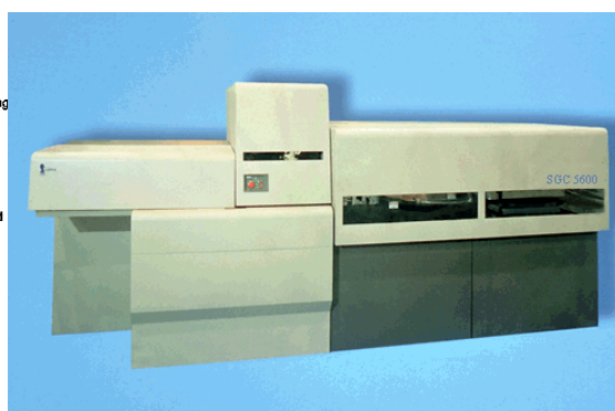
Σχήμα 7.4 : (α). Η διαδικασία Solid Ground Curing - (β). Το σύστημα SGC 5600 της CUBITAL
