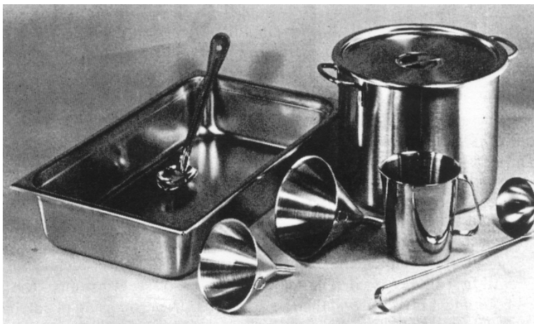
Σχήμα 1.1 : Αντικείμενα που έχουν παραχθεί με διαδικασίες διαμόρφωσης
